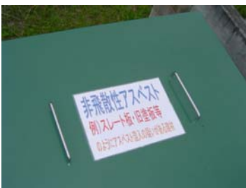
非飛散性アスベスト含有廃棄物は、密閉型の専用ボックスに保管しています
