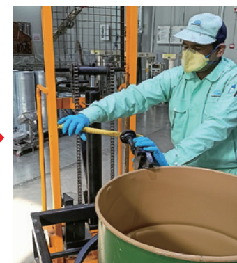
改善後 固定ハンドルを取り付け
