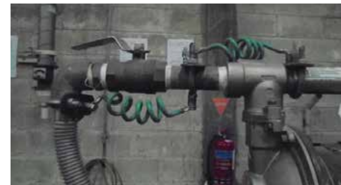
静電気防止のため、シンナーポンプのアースケーブルをアースに接続。
