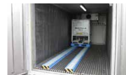
冷蔵コンテナ。レール上に4パレットを収納
